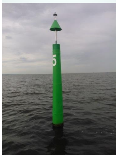
Фонарь ФСН-03МР-М с автономным питанием на буйе №5 (тип Н-400/6) подходного канала Морской Резиденции Президента РФ. п. Стрельна.
